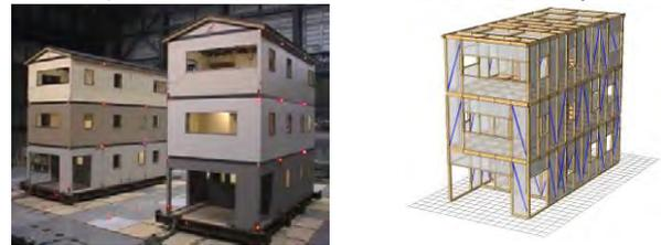
(a) 試験体      (b) 解析モデル
